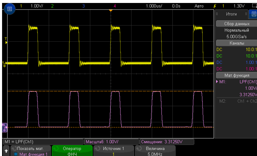
Рис. 16 Пример фильтра низких частот
