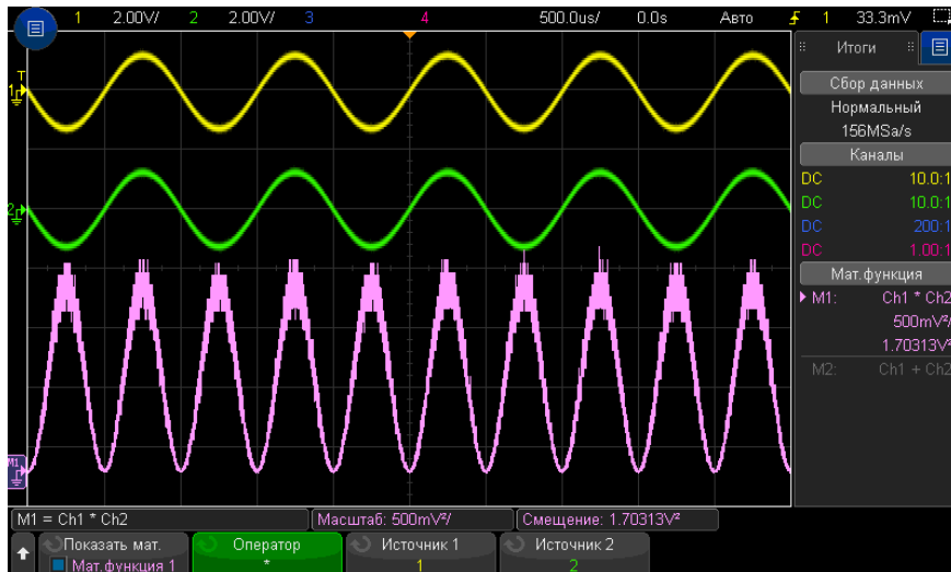
Рис. 7 Пример умножения сигнала канала 1 на сигнал канала 2
